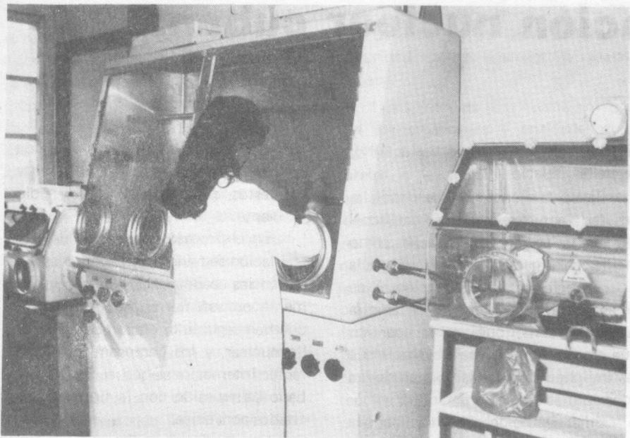
En el laboratorio de radioquímica se emplean medios protectores para el trabajo con elementos radiactivos.
